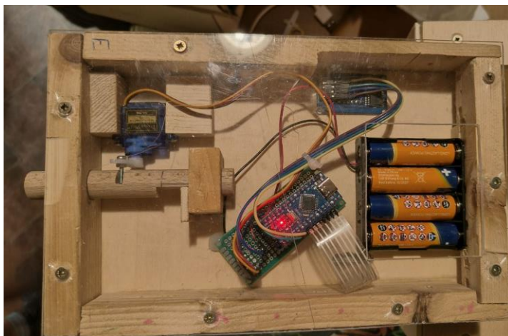
Obrázek 6: Hotové vnitřnosti trezoru
