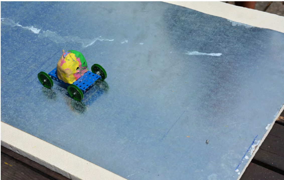
Obrázek 5: Měření velikosti rychlosti dle brzdné dráhy vozíku
