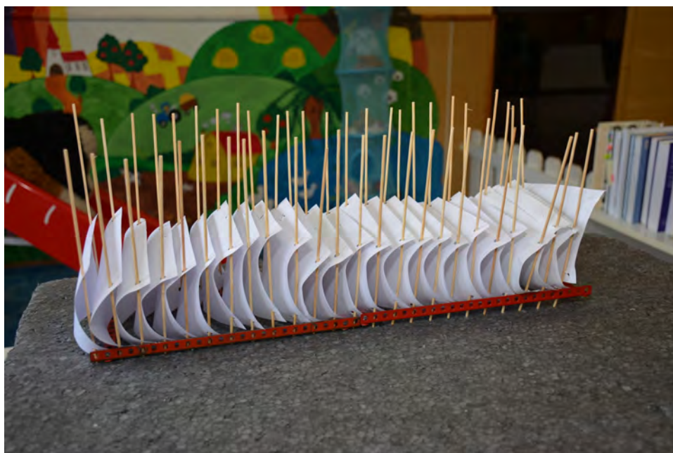
Obrázek 11: Testování, zda dokáže několik vrstev papíru zastavit diabolku
