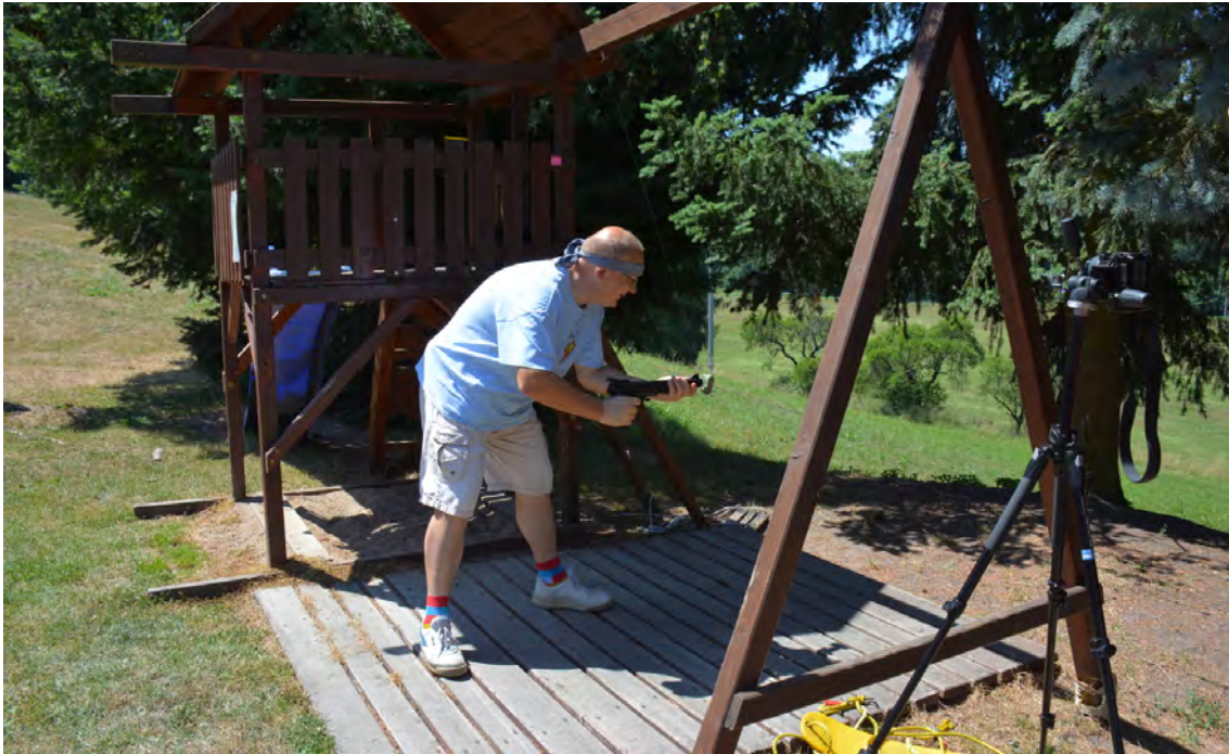
Obrázek 7: Měření velikosti rychlosti dle úhlové výchylky kyvadla
