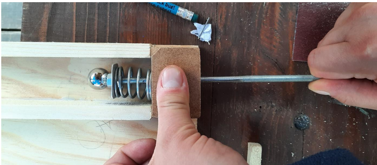
Obrázek 1 - Mechanismus na odpal kuličky v natažené poloze
