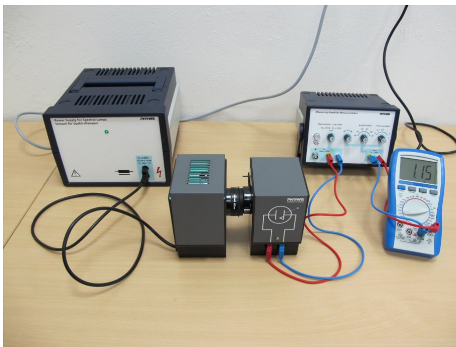
Obr. 5.1 – Aparatura pro měření fotoelektrického jevu
