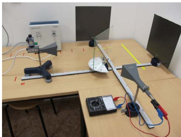
Obr. 4.10 – Sestava Michelsonova interferometru, písmenem V je značen vysílač, D je detektor
