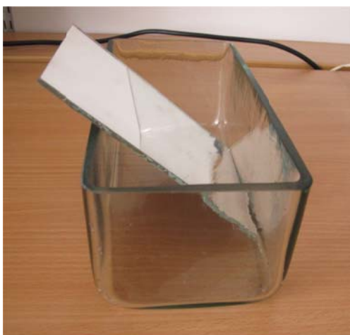
Obr. 4.16 – Jednoduchá náhrada hranolu pro rozklad světla
