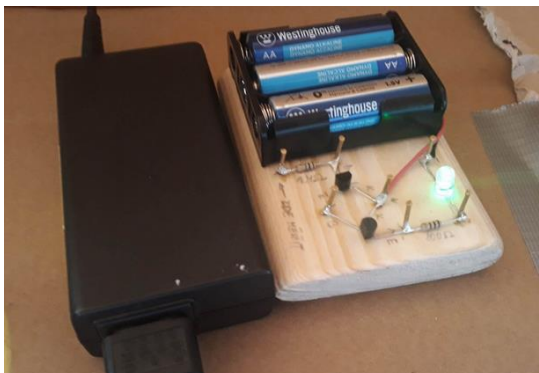
Obrázek 9: Svítící ledka při přiblížení bodu A k nabíječce od notebooku.
