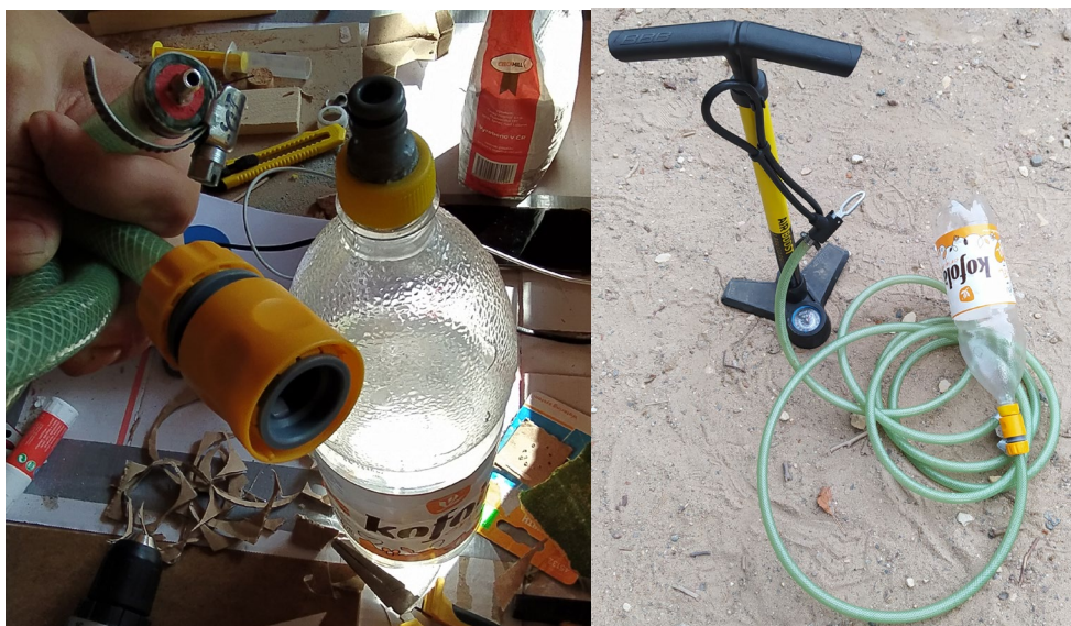
Obr. 1: Vlevo ventilek, rychlospojka a láhev s tryskou, vpravo zapojená sestava s pumpou
