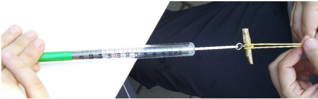
Obr. 2: Zkouška pevnosti v tahu
