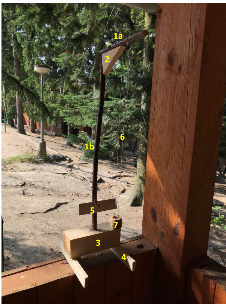
Obrázek 1 - konstrukce matematického kyvadla s možností záznamu kmitání
